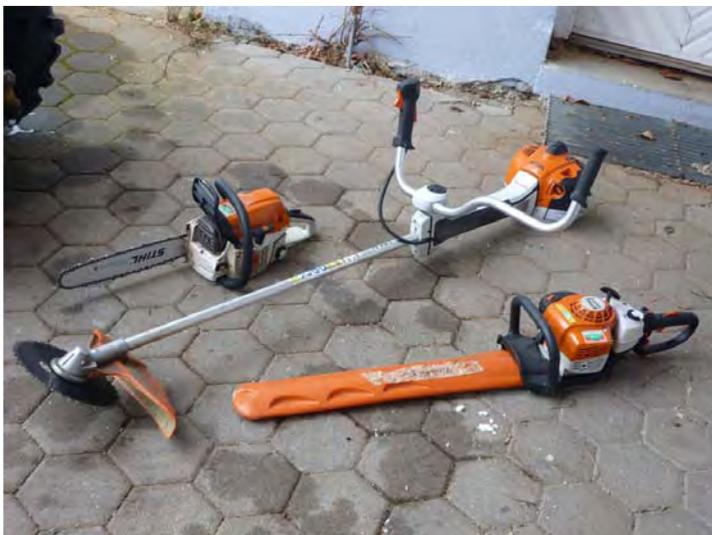
Die Motorsense (Bild Mitte) kommt bei Entbuschungen und Mähen von unwegsamem Gelände zum Einsatz. Motorsäge und Heckenschere verwenden wir hauptsächlich zum Pflegen und zurückdrängen von Hecken.
