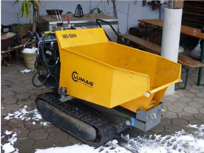
Mit dem Mini-Dumper können wir Mähgut aus den Flächen holen die nicht mit größeren Maschinen zu befahren sind: Durch seinen Kettenantrieb ist er bestens zum Arbeiten auf Moosflächen geeignet und erleichtert uns die Arbeit dort sehr.
